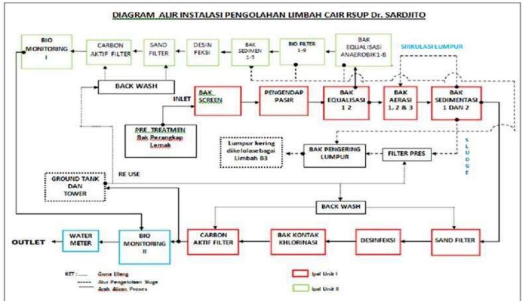
Gambar 3. Diagram Alir Instalasi Pengolahan Limbah Cair RSUP Dr. Sardjito
